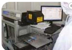
Photo 6. Etiquetage laser pour le suivi des produits
